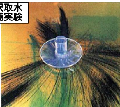
選択取水設備は、貯水池の表層・中層・低層の任意の層から取水が可能な設備で、近年では、冷濁水や富栄養化の問題に対応するため、密度成層を利用した取水操作を行っているダムもあります。
