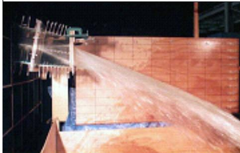
バスタブ型越流堤(越流式放流設備)
