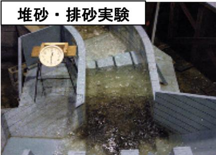
貯水池へ流入した土砂がどのように堆砂・排砂されるのかを実験により再現します。
