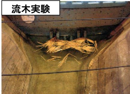
貯水池に流れ込んだ流木の挙動について、実験により再現します。
